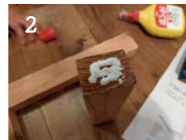
2 接合面にボンドをつける。
