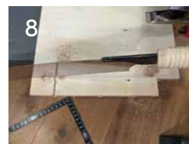
8 合板の角をノコギリで落とす。切り目が少しはみ出ても、見えなくなる。
