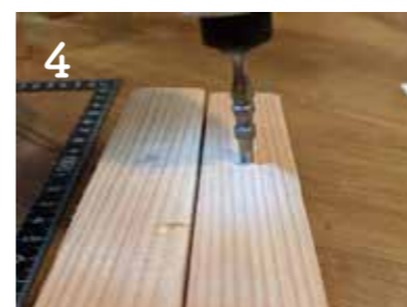
4 ビスを打つ前にプラスビットでグリグリ穴を広げると、割れにくくなる。
